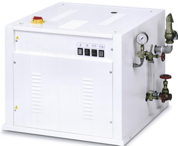
**Modello Maxi 60:** Generatore di vapore elettrico ed automatico, disponibile con potenza variabile da 20 a 60 kW. Maxi 60 può essere alimentato direttamente dalla rete idrica o da uno speciale serbatoio in acciaio inox. La caldaia viene fornita con doppia resistenza ed ha quindi la possibilità di funzionare con potenza dimezzata
