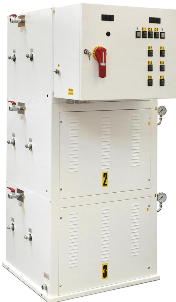
**Modello Maxi 180:** Generatore di vapore elettrico ed automatico, disponibile con potenza variabile da 60 a 180 kW, composto da tre corpi caldaia. MAXI 180 può essere alimentato direttamente dalla rete idrica o da una vasca di recupero condense in acciaio inox.
