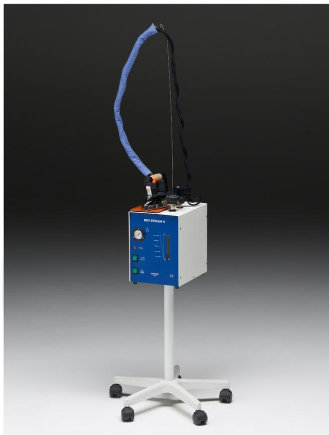
Generatore di vapore con caldaia industriale da 5,00Lt. pressostato per l'estro controllo della pressione del vapore, controllo visivo del livello acqua in caldaia, valvola a sfera per lo scarico d'acqua e depositi, elettrovalvola con regolazione del flusso di vapore, tappo di sicurezza, No. 02 termostati di sicurezza a protezione della resistenza in caso di mancanza d'acqua ed a protezione del boiler contro le sovratemperature.
