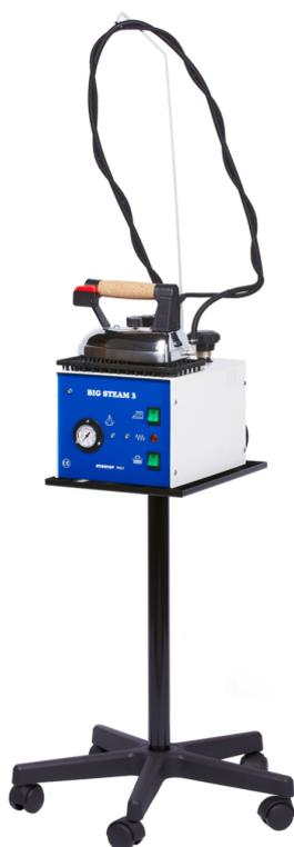
Generatore di vapore con caldaia da 3,00Lt. pressostato per l'esatto controllo della pressione del vapore, elettrovalvola con regolazione del flusso di vapore, tappo di sicurezza, No. 02 termostati di sicurezza a protezione della resistenza in caso di mancanza d'acqua ed a protezione del boiler contro le sovra temperature, allarme acustico per mancanza d'acqua nella caldaia.
