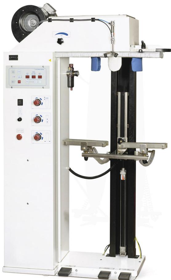
**Modello T-3000:** Manichino stirapantaloni pneumatico, da collegare a fonte di vapore esterna e ad aria compressa centralizzata.
