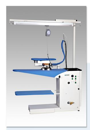
**Modello 604**: Banco da stiro aspirante riscaldato predisposto per l'applicazione delle forme stiramaniche, grazie al generatore automatico al suo interno può alimentare in totale autonomia un ferro, due ferri oppure 2 ferri da stiro e una pistola a vapore.
