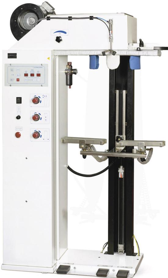
**Modèle T-3000:** Mannequin pneumatique pour le repassage des pantalons, pour branchement sur réseau vapeur et air comprimé.
