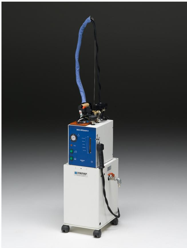
Générateur de vapeur industriel avec chaudière ronde 5 litres, pressostat pour contrôle exact de la pression de la vapeur, contrôle visuel du niveau d'eau dans la chaudière, soupape à bille pour le déchargement de l'eau et des dépôts, électrovanne avec la régulation du flux de vapeur, soupape de sécurité, No.2 thermostats de sécurité à protection de la résistance en cas de manque d'eau et à protection de la chaudière en cas de surtempératures.
