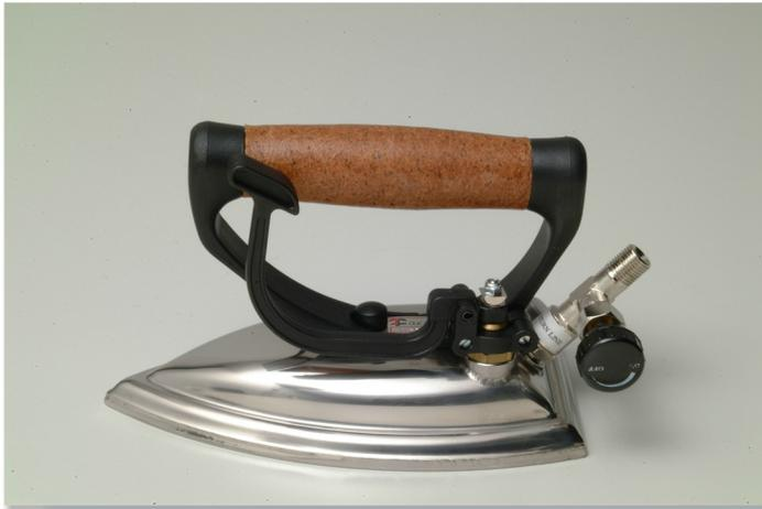
fer à repasser pour l'usage industriel 1,3 Kg chauffé à vapeur, cette caractéristique donne à la plaque repassante la possibilité de travailler avec température plus basse et donc d'empêcher, en travaillant sûr certains tissus, de donner le "Lustre" au tissu, en plus sans la résistance il y a une économie d'énergie.
